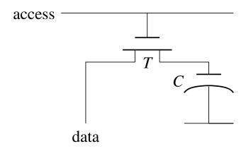
réalisation compacte (p.ex. un seul transistor + capaciteur)
