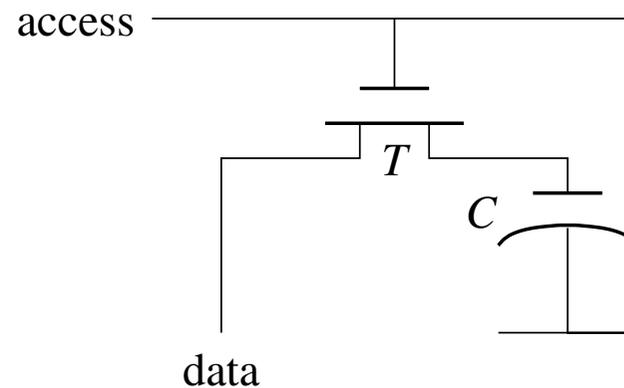
réalisation compacte (p.ex. un seul transistor + condensateur)
