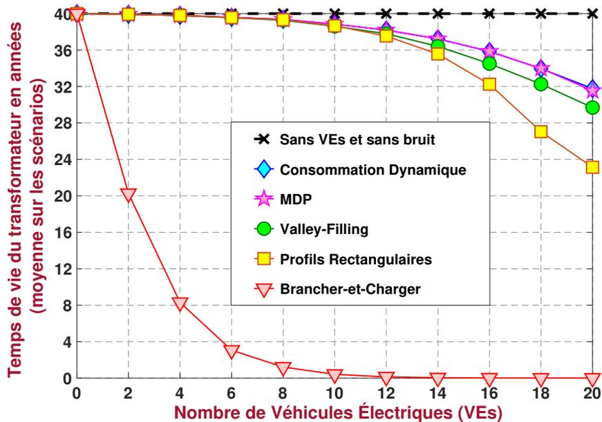
Figure A.2: Temps de vie du transformateur du RD en fonction du nombre de Véhicules Électriques ( $I$ ), sous l'hypothèse d'une prévision imparfaite sur la consommation non-contrôlable réelle (dans chaque scénario) basée sur un  $\text{SNR} = 15 \text{ dB}$ . (Cas centralisé).
