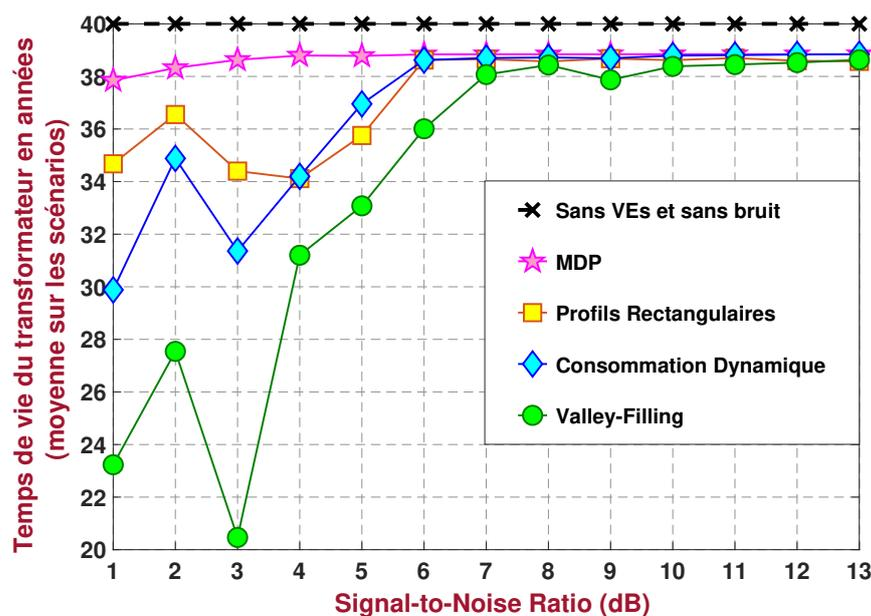
Figure A.3: Temps de vie du transformateur du RD en fonction des bruits de prévision sur le la consommation non-contrôlable réelle (dans chaque scénario), pour  $I = 10$  VEs. (Cas centralisé).
